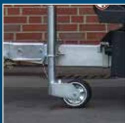
Ruota di sostegno stabile (opzionalmente come ruota di sostegno doppia)
