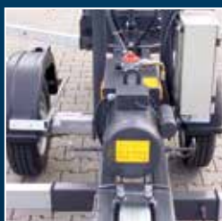
Assale restringibile, ampiezza di manovra 0,89 m (opzionale)
