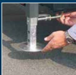
Stabilizzatori zincati anticaduta con fermo d'arresto
