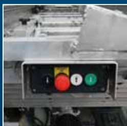
Comando elettrico con avanzamento micrometrico (opzionale)
