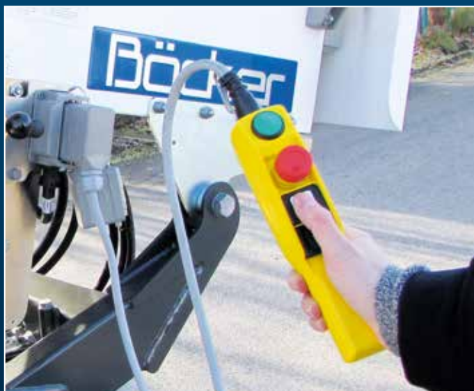
Comando in basso tramite pulsantiera di comando con cavo da 4 m
