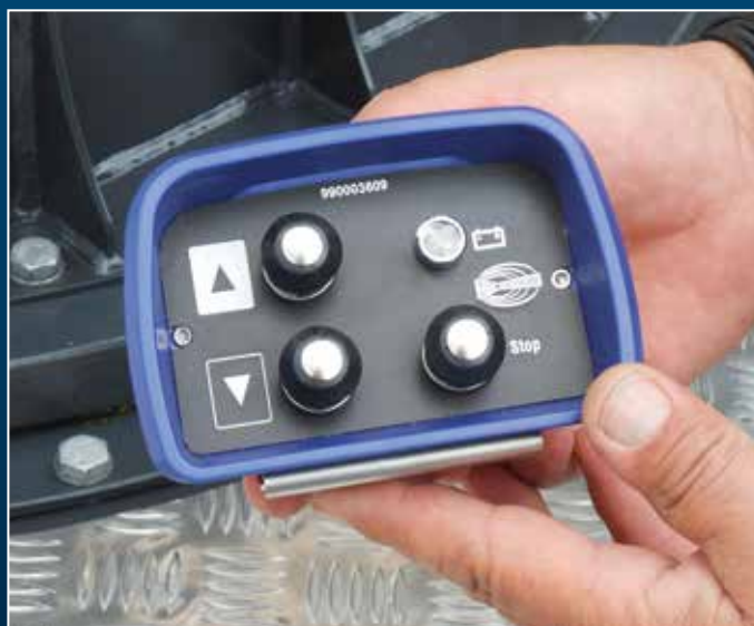
Comando opzionale in basso tramite radiocomando
