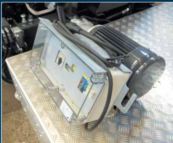
Motore elettrico aggiuntivo da 230 Volt (opzionale)
