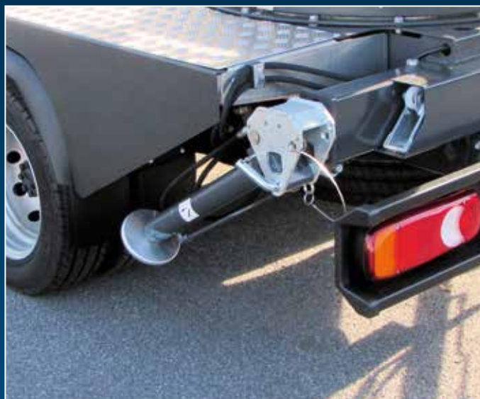
Stabilizzatori idraulici meccanicamente estraibili e orientabili a 60°
